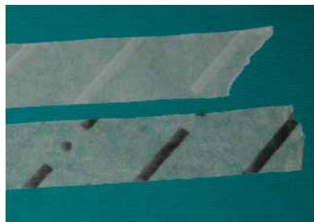
Resim 20. Kendinden yapışkanlı şerit şeklinde dış kimyasal indikatör. Şeritlerin üzerindeki kimyasal indikatör doğru sterilizasyon süreci ile belirginleşir
