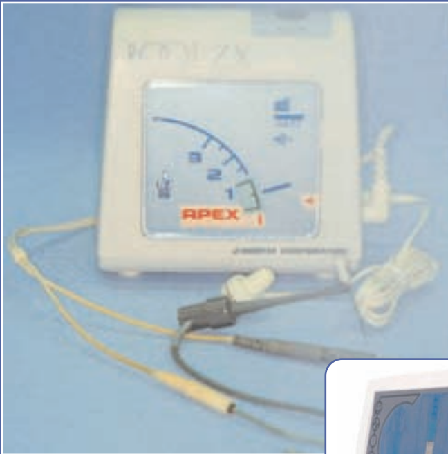
Resim | 4 Üçüncü jenerasyon elektronik apeks belirleyicilerden Root ZX
